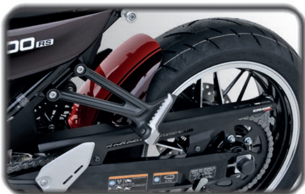
Garde-boue AR. bicolore + carter de chaîne en aluminium
