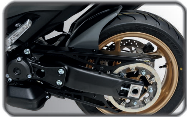
Garde-boue AR. + carter de courroie en Aluminium en 2 parties
